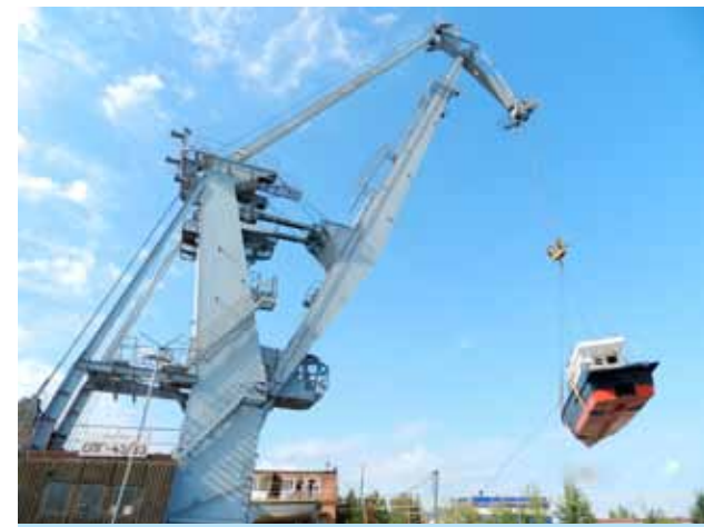
Экипаж СПГ-43/83 выполняет погрузку катера для ремонта.
